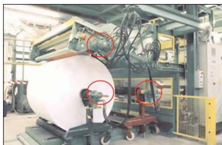
Рис. 17. Пример потенциального использования энкодеров DKS40: печатная машина для изготовления упаковочного материала
