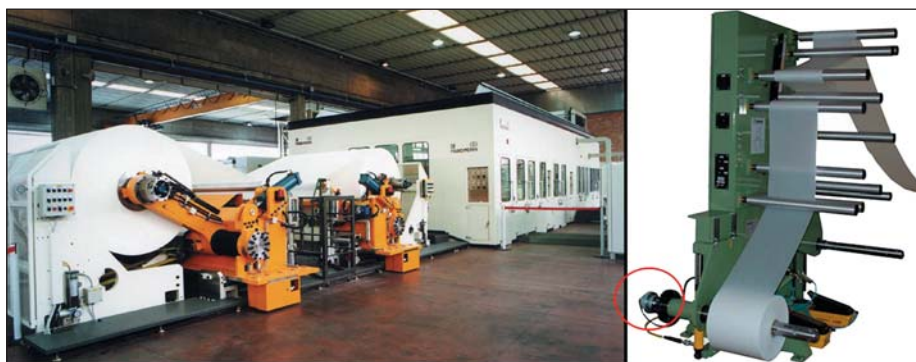
Рис. 16. Пример потенциального использования энкодеров DKS40: печатно-резательная машина для изготовления гигиенической бумаги
