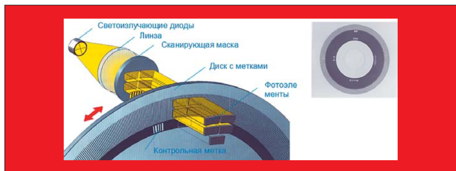
Рис. 8. Конструкция стандартного оптического энкодера
