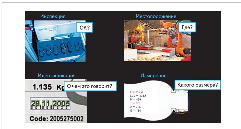
Рис. 1. Задачи, решаемые машинным зрением
