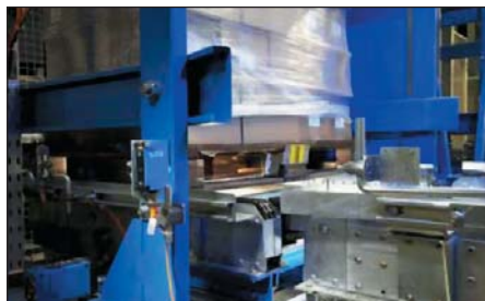
Рис. 8. Применение датчиков W27 для обнаружения паллет на складе
