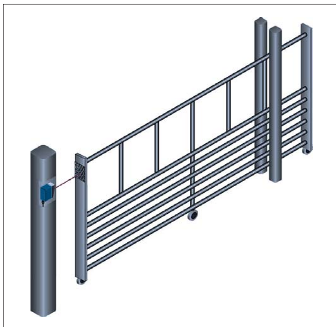
Рис. 12. Пример использования датчиков DL60 для автоматизации ворот
