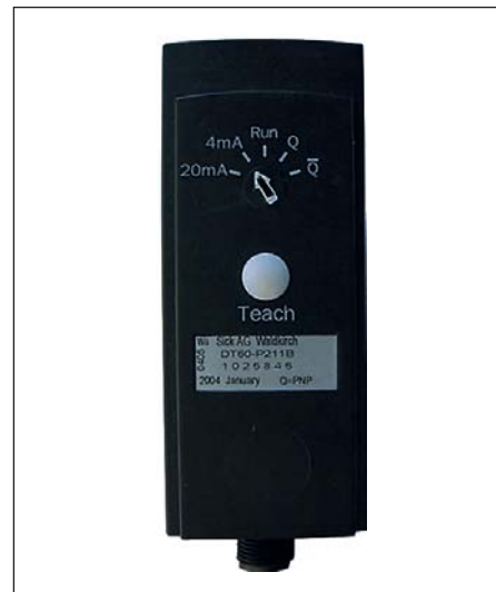
Рис. 4. Тыльная сторона датчика DT60 с кнопкой настройки Teach и индикатором выбора режимов
