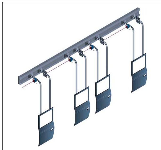
Рис. 13. Применение датчиков DL60 для поддержания заданных промежутков на конвейере в автомобильной промышленности
